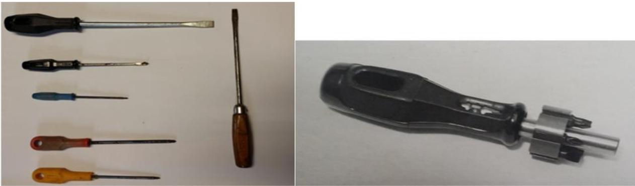
*Schraubendreher mit Flachgriff und Loch*: linkes Bild (gelb u roter Griff) große Kraftübertragung möglich, ergonomisch ungünstig
