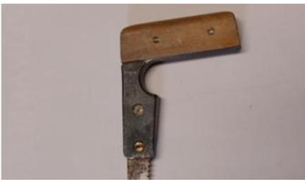
Muster/Prototyp: Werkstoffkombination Holz mit geschäumten Kunststoff nicht umgesetzt
